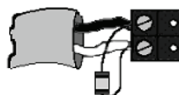
Figure 9: Détail de la résistance de terminaison
