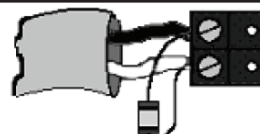
Figura 9: Detalle de la resistencia terminal
