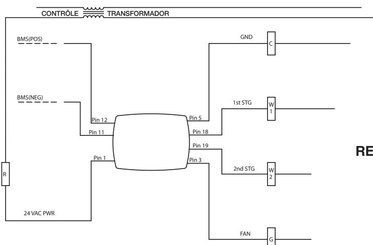
Figure 2: MUH/HUHAA Câblage de chauffage
