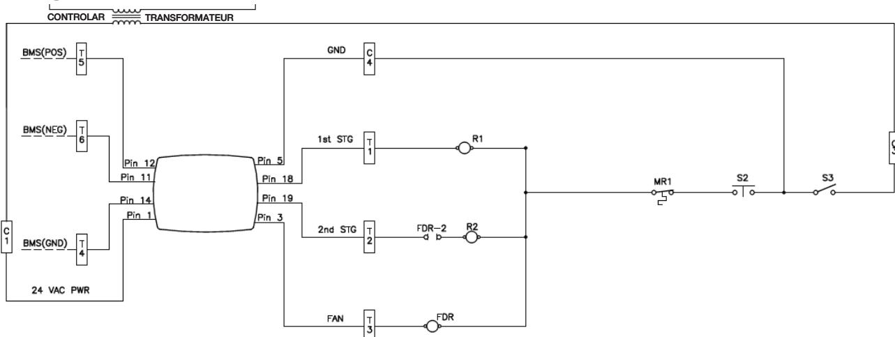
Figura 1: Cableado del calentador de la unidad de gabinete
