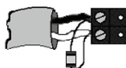
Figure 9: Détail de la résistance de terminaison
