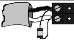
Figura 9: Detalle de la resistencia terminal
