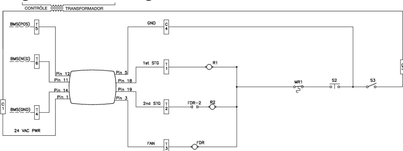
Figure 1: Câblage de l'appareil de chauffage en armoire
